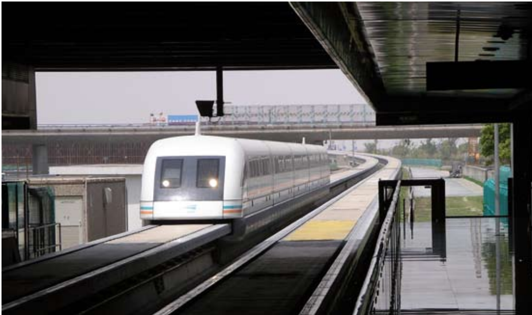
Maglevtågen, som togs i trafik 2003, kör den 30 km långa sträckan till Longyanglu på drygt 7 minuter. Toppfart 431 km/tim.
